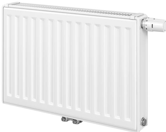
Le T6 3010, radiateur panneau à raccordement central, est délivré avec un insert thermostatique universel M30x1,5 pré-monté en usine pour plus de flexibilité dans le choix de votre tête thermostatique. Les nombreux avantages telles que la pression de service de 10 bar, la canne intégrée en forme de T, la finition aux bords arrondies ainsi que les joues latérales et la grille supérieure sont conservées.
